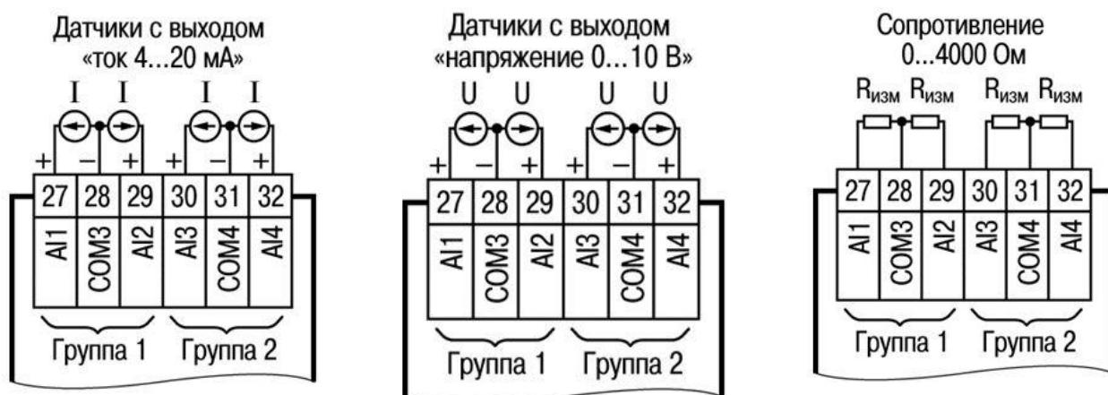
Рисунок 1 – Схема подключения аналоговых датчиков к ПР200
