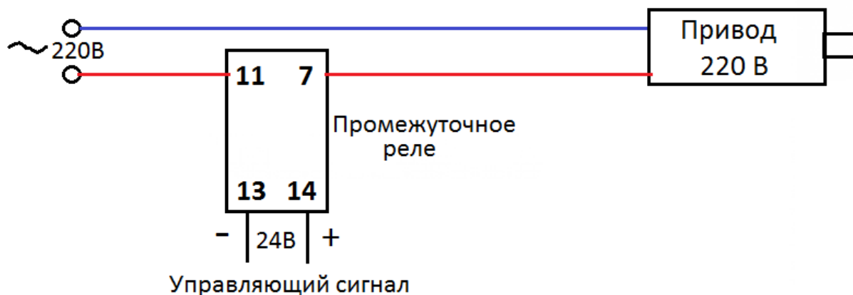
Рисунок 2 – Схема управления приводом 220 В через промежуточное реле.
