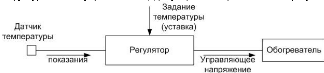
Рисунок 1 – Структурная схема управления ПИД-регулирования
